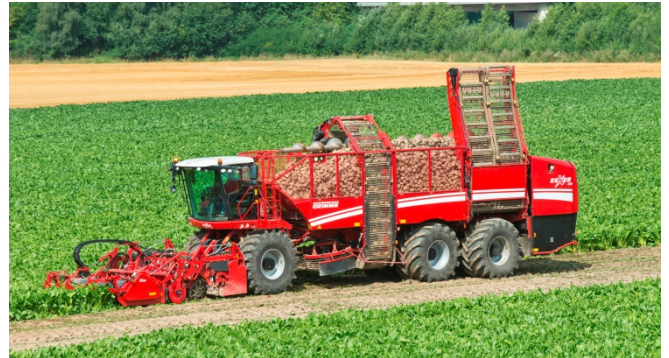
Der 6-reihige, 625 PS starke REXOR 630 ist ein 3-achsiger Rübenroder mit 30 Tonnen (45 m 3 ) Großbunker
